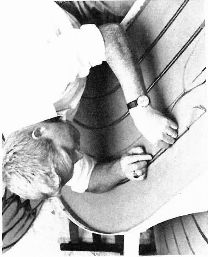
Vill man inte använda "roller" vid läggningen av teipen, kan man göra som Lennart Axelsson i Enskede Miniracing — använda fingrarna!
